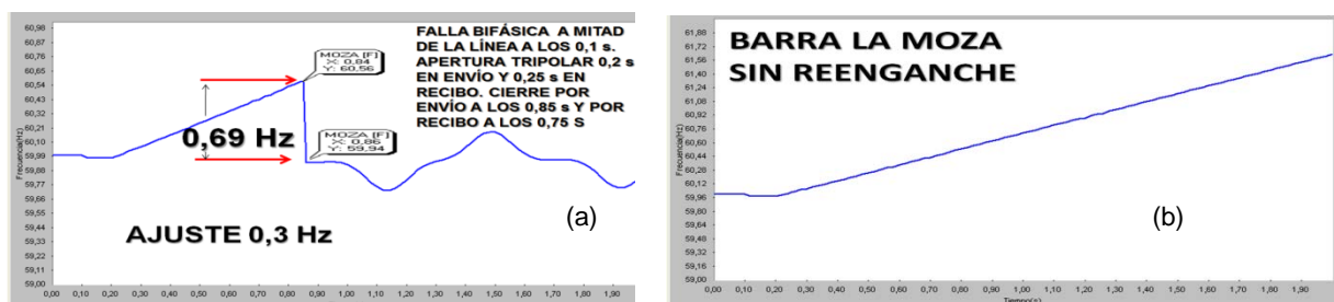
Fig. 4. Comportamiento de la frecuencia cuando la transferencia de potencia se encuentra en dirección contraria a La Moza, a) en vísperas de un reenganche tripolar y b) barra sin reenganche.
