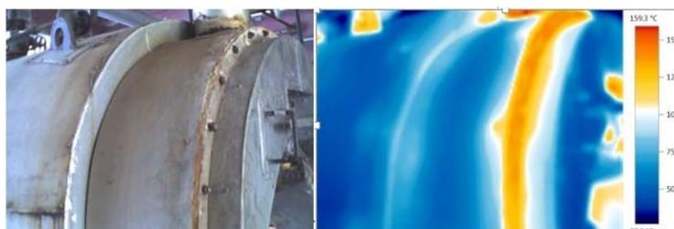
Fig. 5. Imagen real y termográfica de la cara posterior de la caldera.
