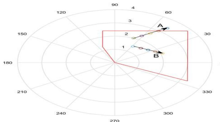
Fig. 6. Ubicación en el plano X-R de la falla para valores de resistencia de arco, A-con trasferencia previa desde SEN 2 a SEN 1 (Valores Tabla 2), B-con trasferencia de Sistema 1 a Sistema 2 (Valores Tabla 2).
