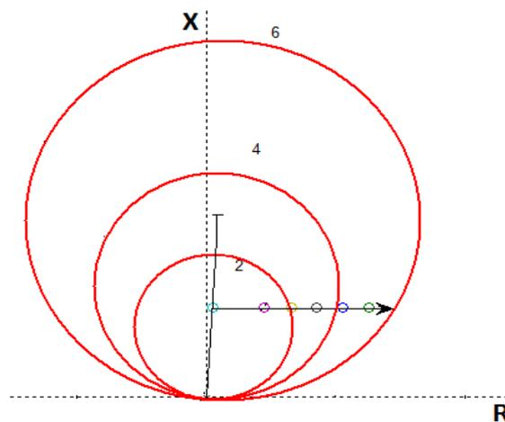
Fig. 4. Ubicación del CC en las zonas de operación del relé de distancia ubicado en la barra 1 con una resistencia de falla de 0 hasta 1,2 Ohm en el sentido de la saeta.
