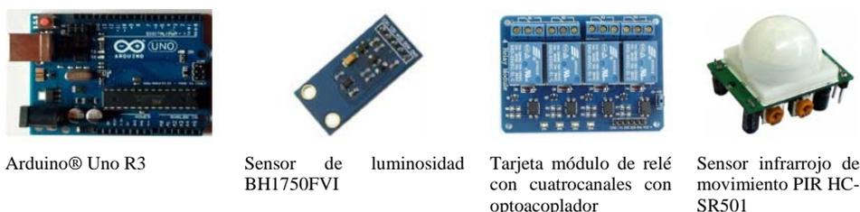
Fig.5.Principales dispositivos de la maqueta.
