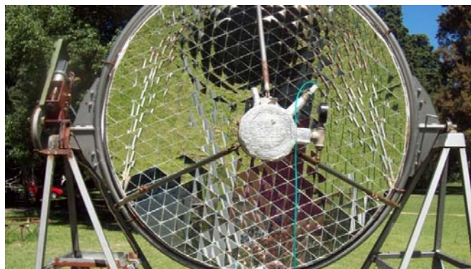
Fig. 2. Disco parabólico construido con facetas triangulares.
