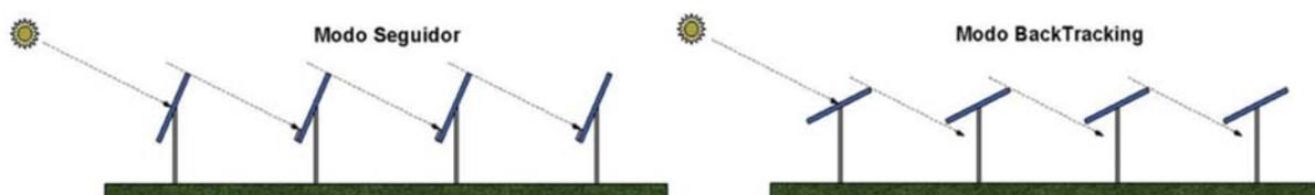
Fig. 2. Seguimiento sin *backtracking* y con *backtracking* [4].
