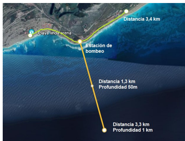
Fig. 4. Ubicación de la estación de bombeo del sistema SWAC y ruta propuesta para los sistemas de suministro de agua de mar y distribución de agua enfriada. Fuente: Elaboración propia
