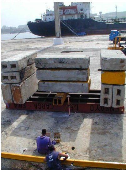
FIGURA 4. Ensayo de carga en el lugar (agosto 2003)
