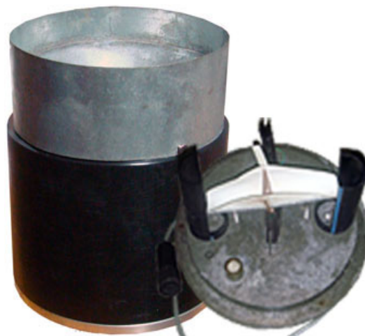
Figura 3. Vista general del pluviógrafo cubano y detalle de su balancín
