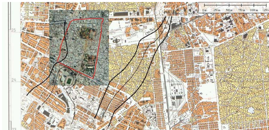
Figura 1. Análisis preliminar de datos planimétricos y altimétricos sobre el mapa 1:25000. Se superpone la ortofoto satelital sobre la cartografía. El polígono delimita el barrio Marzal. Obsérvense las escasas curvas de nivel en el área de interés
