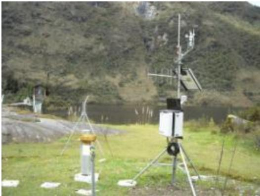
**Figura 4. Estación meteorológica**
