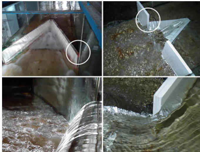
Figura 6. Imagen de las obras con contracciones y sin ellas incluyendo detalles
