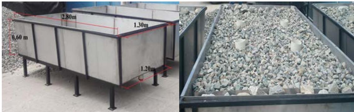
**Figura 2. Medidas de los reactores, material de soporte y pozos de muestreo**
