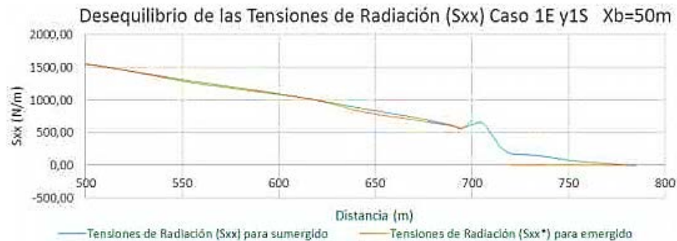
Figura 20. Tensiones de radiación en rompeolas emergido y sumergido para X_b=50 m
