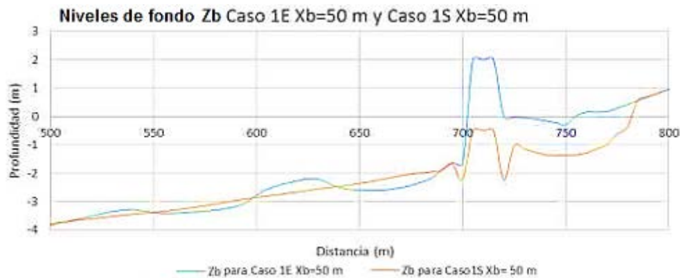
Figura 21. Niveles de fondo en rompeolas emergido y sumergido para X_b=50 m
