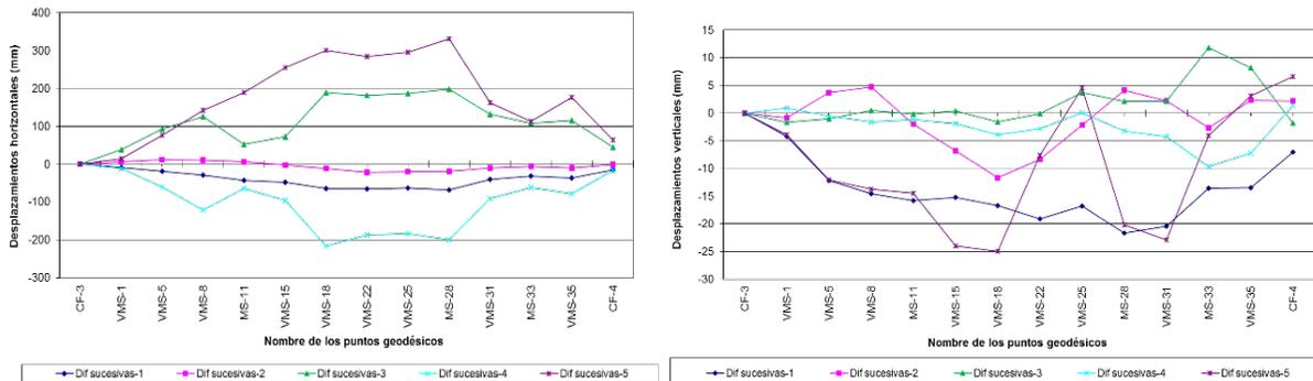
**Figura 4. Diferencias sucesivas de las desalineaciones para todos los Ciclos de la Línea A**
