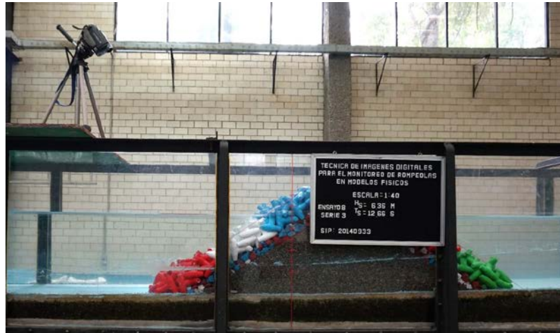
Figura 6. Colocación de la cámara frente a la estructura.
