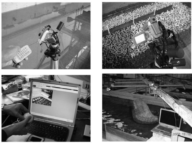
Figura 1. Cámara de video digital controlada remotamente acoplada a una Laptop para captura de datos (Phelp and Tulsı 2006)
