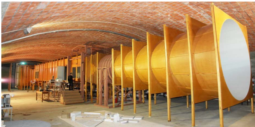
Figura 4. Arreglo de los dispositivos de simulación para generación del flujo turbulento en el túnel de viento
