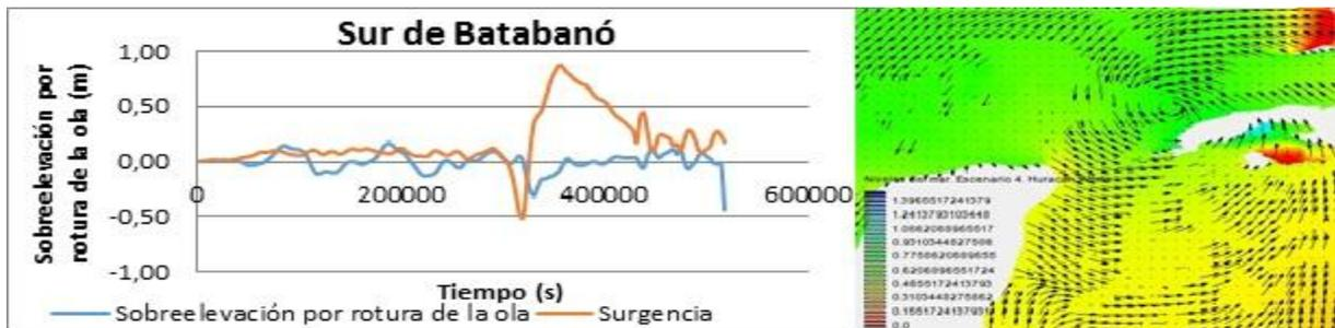
**Figura 17.** A la izquierda sobre elevación por rotura de la ola y surgencia y a la derecha niveles del mar y comportamiento de los vientos durante el huracán Gustav en el Sur de Batabanó
