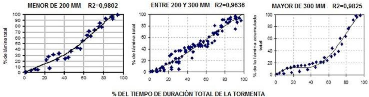
**Figura 7. Diagramas de masa característicos en función de la lámina máxima (Planos 1991)**
