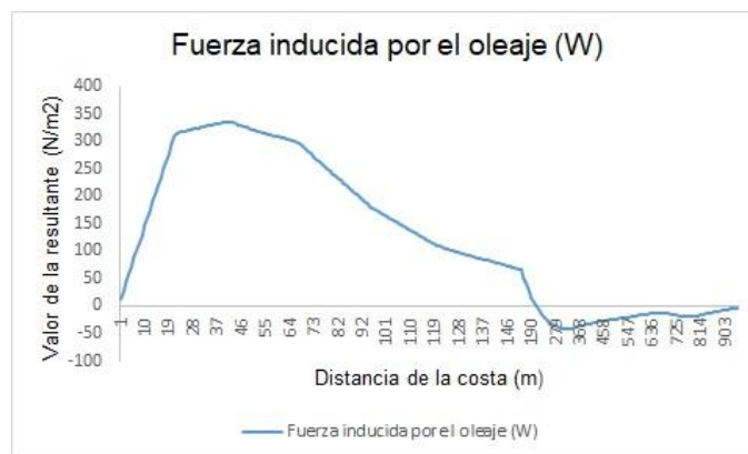
Figura 10. Resultante de la fuerza inducida por el oleaje (W)
