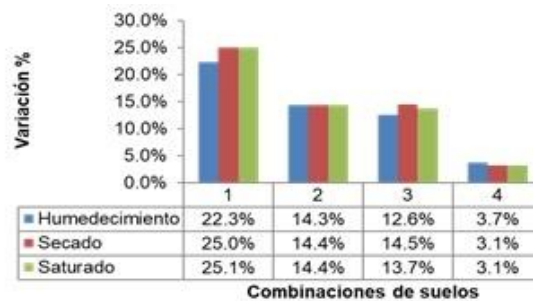
Figura 8. Variación porcentual del factor de seguridad con pendientes 1:2 y 1:1,5 de las combinaciones establecidas, con colchón de drenaje
