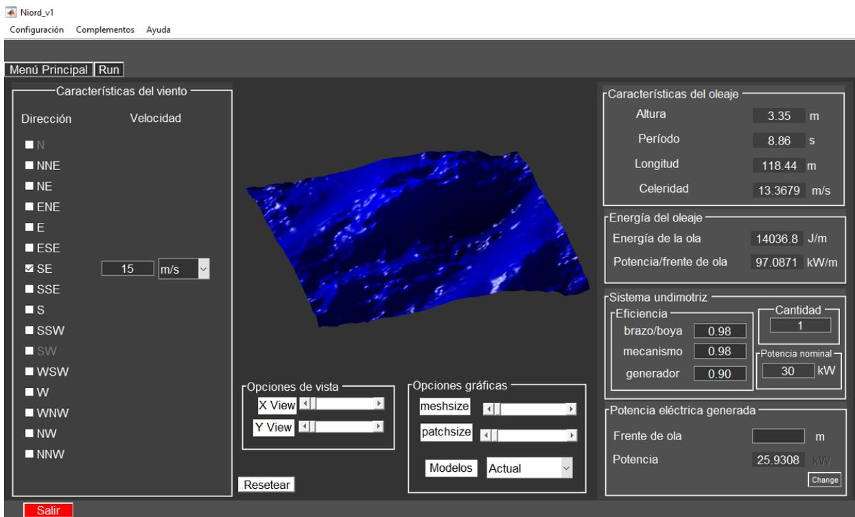
**Figura 10. Simulación del Niord para un viento incidente proveniente del Sur-este con una velocidad de 15 m/s**
