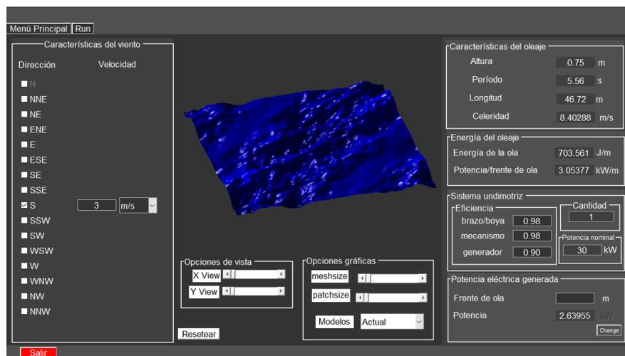
**Figura 9. Simulación del Niord para un viento incidente proveniente del Sur con una velocidad de 3 m/s**
