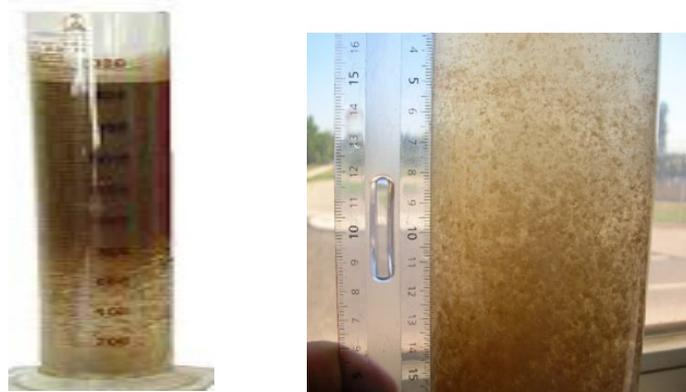
**Fig. 5.** – Suspensión típica de lodo abultado (izquierda) y de tipo punta de alfiler o pin point (derecha).
