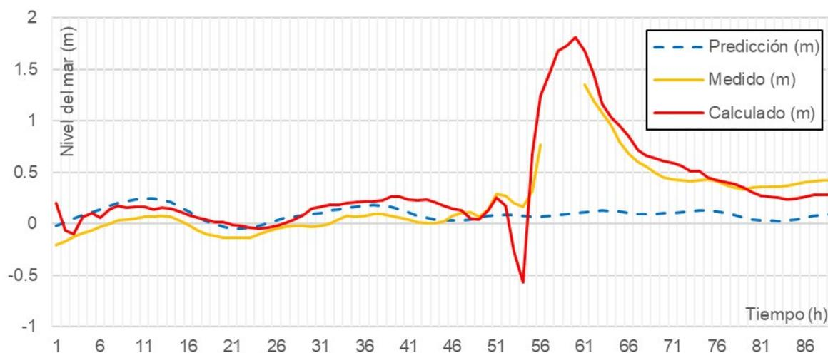
Fig. 7. – Comparación de los niveles del mar calculados en la modelación con la predicción y lo medido por la estación 8761305 al paso de Gustav (2008)
