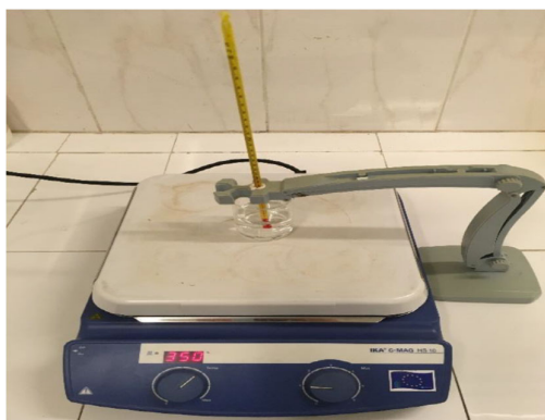
Fig. 7. - Diseño experimental para determinar punto de ebullición.
