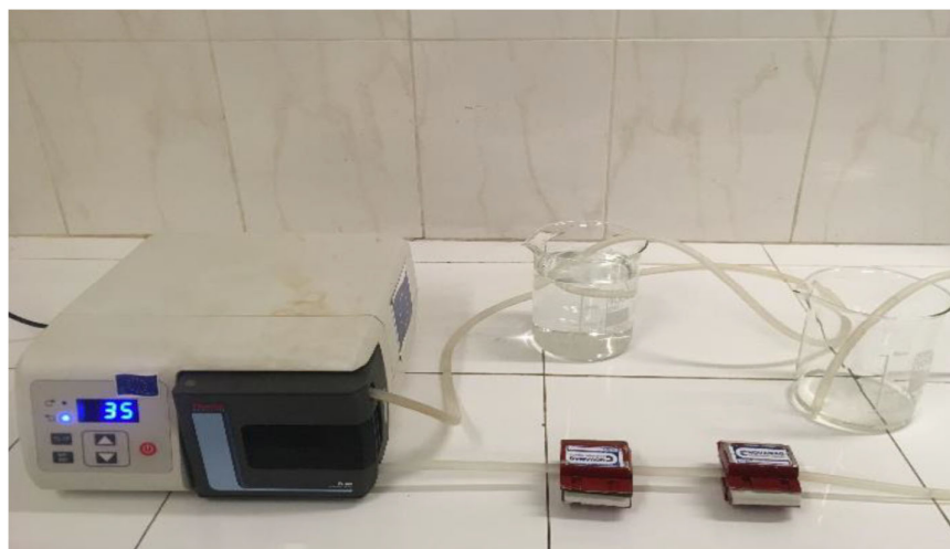
Fig. 2. - Sistema experimental para el tratamiento magnético
