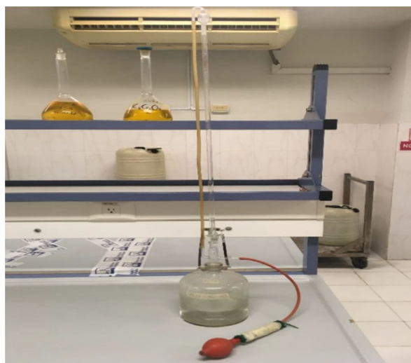
Fig. 6. - Diseño experimental para determinar dureza
