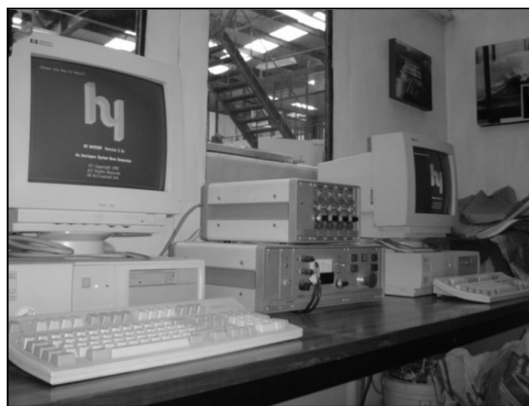
Figura 2. Equipos de cómputo para control del generador y del equipo de medición de oleaje
