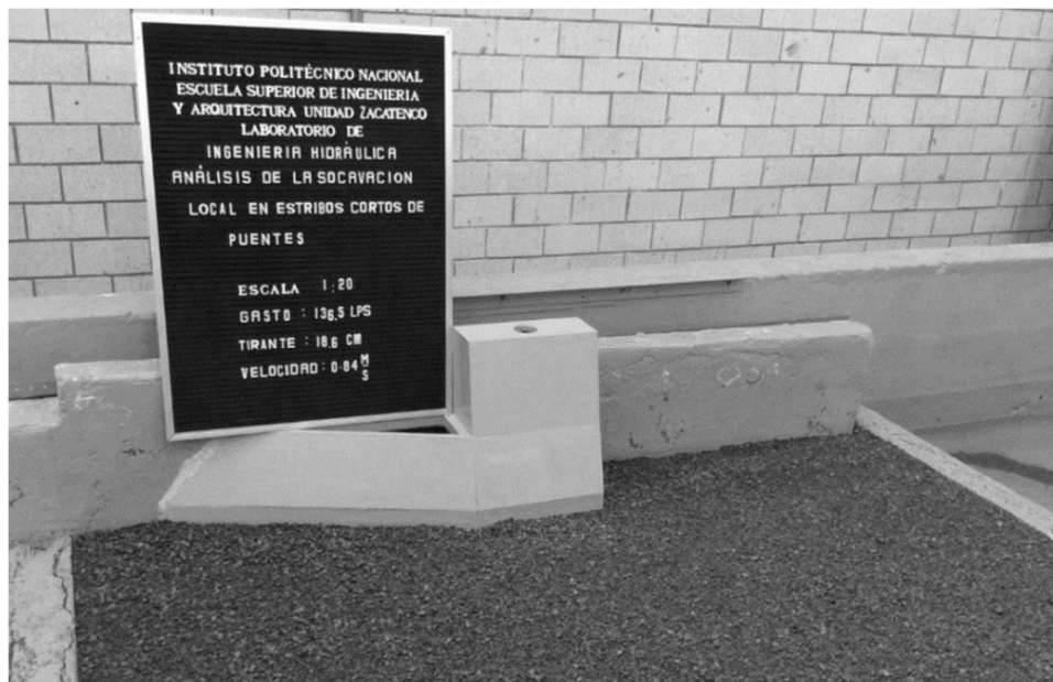
Figura 6. Vista del canal después del ensayo 16, con estribo con alerón a 20°.
