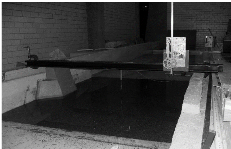
Figura 5. Vista del estribo con alerones a 45° y el limnómetro móvil.
