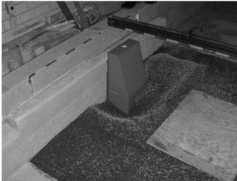
Figura 4. Estribo original después del ensayo 5 serie1, con gran profundidad de socavación.
