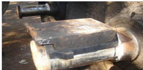
**Fig. 4.** Elementos del cojinete de deslizamiento
