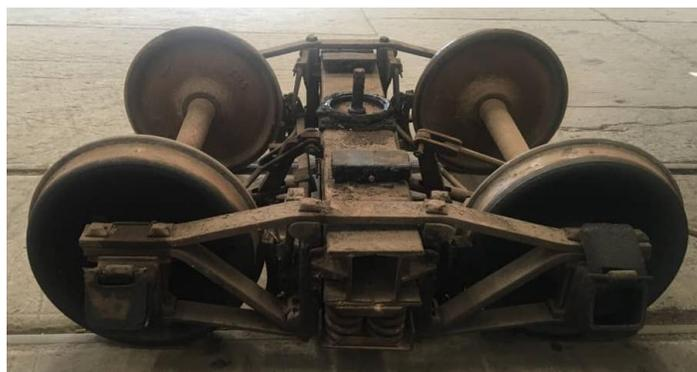
**Fig. 2.** *Truck* de bandas arqueadas antes de la modificación.
