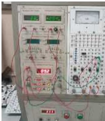
Figura 7. Circuito eléctrico sencillo de la práctica de laboratorio # 8 implementado en la estación de laboratorio midiendo el aporte de la fuente de 9,2 V. Fuente: elaboración propia.
