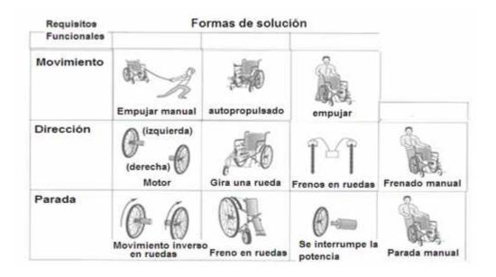
Figura 1 – Ejemplo de una tabla de análisis morfológico de una silla de ruedas.
