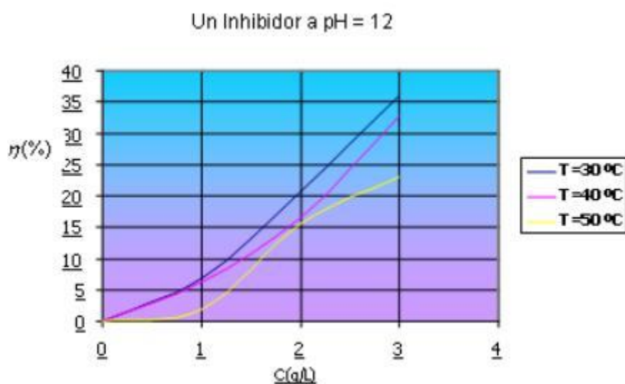
Fig. 1 Gráficas de eficiencia de inhibición en función de la temperatura y concentración para un inhibidor a pH igual a 12.
