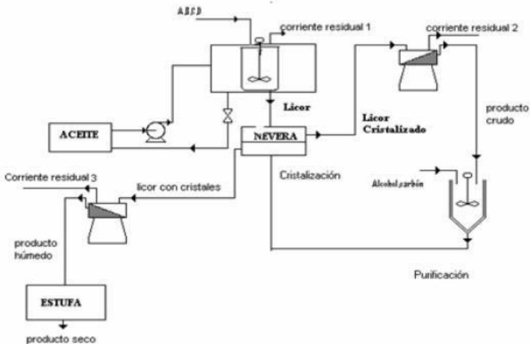
Fig. Diagrama de flujo del proceso de síntesis y purificación de G-0.
