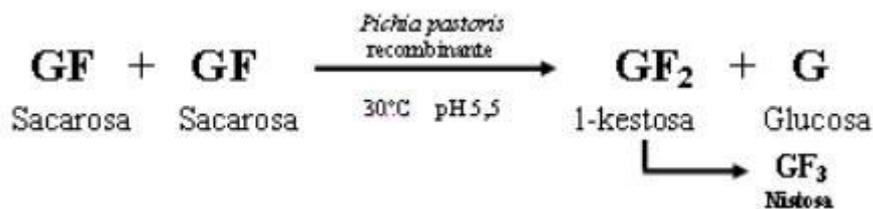
**Fig. 1** Representación esquemática de la reacción de síntesis FOS, catalizada por células de *Pichia pastoris* recombinante inmovilizadas en alginato de calcio.
