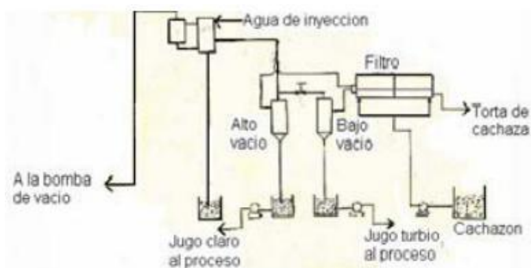
Estación de filtros
