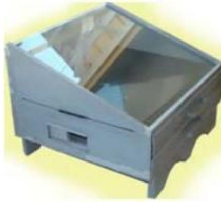
**Fig. 1** Secador solar diseñado y construido.
