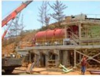
**Fig. 2** Lavador Cilíndrico Industrial.
