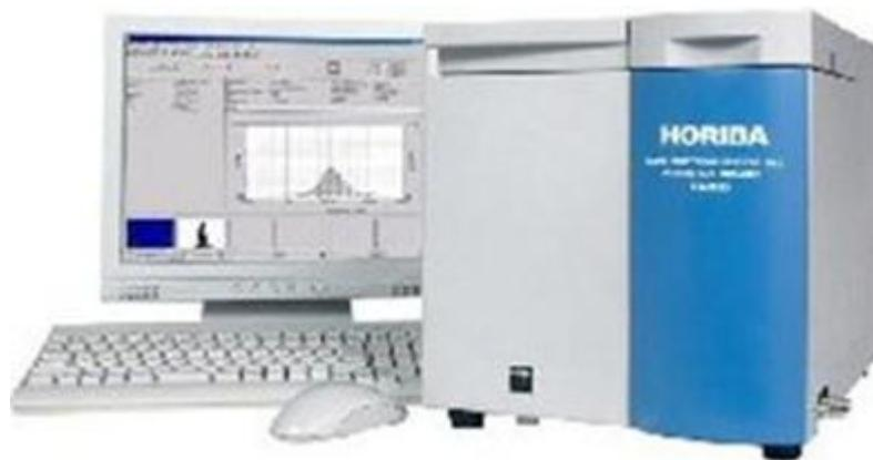
**Fig.3** Aparato de medición de tamaño y de forma de partícula.
