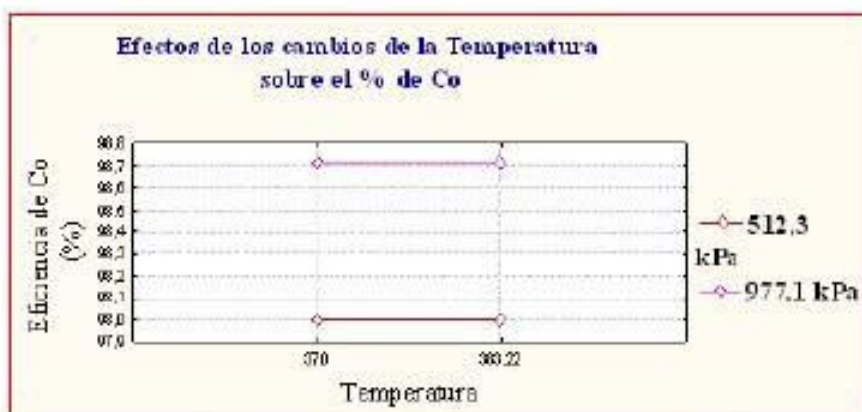
Fig.6 Efecto de los cambios de la temperatura sobre la eficiencia de precipitación del Co.
