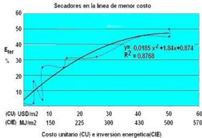
**Fig. 2** Línea de menor costo para una muestra típica de secadores baratos.
