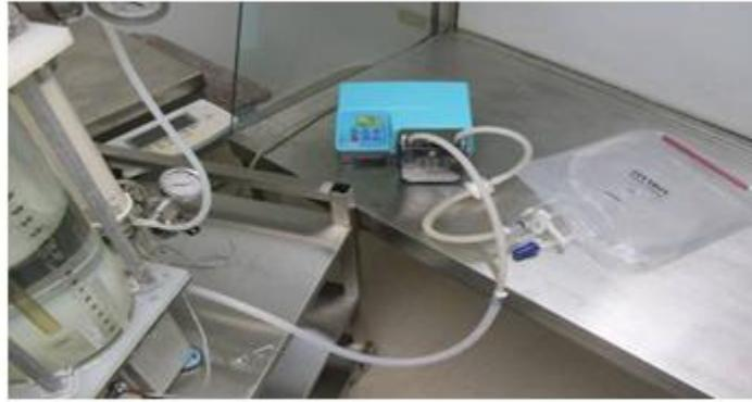
**Fig. 4** Sistema cerrado confeccionado para la Filtración Final
