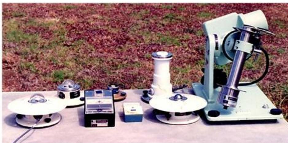
**Fig. 2** Instrumentos para medir la Radiación solar- Global, Directa y Ultra Violeta
