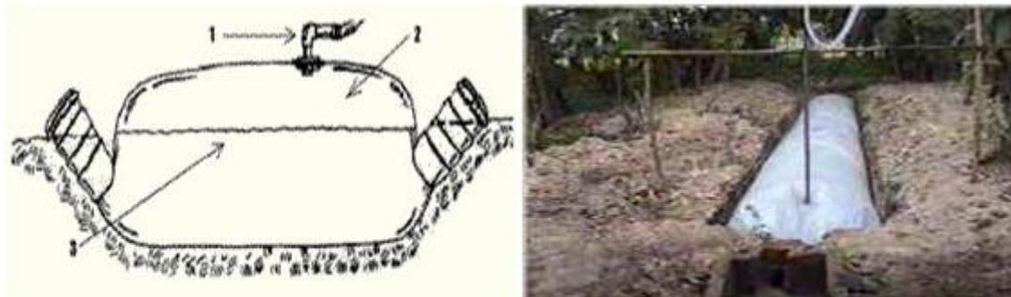
1- Válvula de salida 2-Almacenamiento de biogás 3-Nivel del agua con materia orgánica
