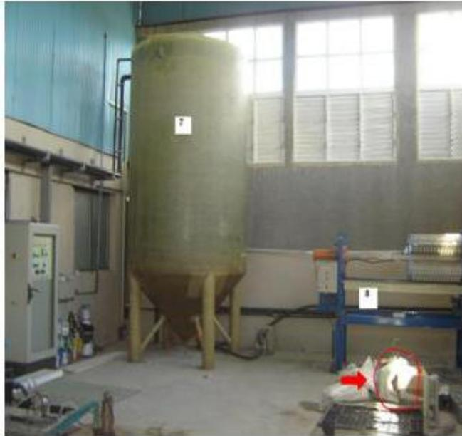
**Fig.3** Sedimentador y filtro prensa.
