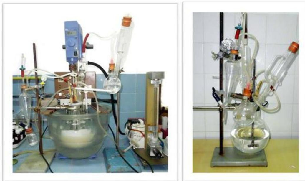
**Fig.2** Fotografía del biorreactor y sus dispositivos auxiliares. Izquierda: Biorreactor en funcionamiento. Derecha: Biorreactor preparado para la esterilización en autoclave.
