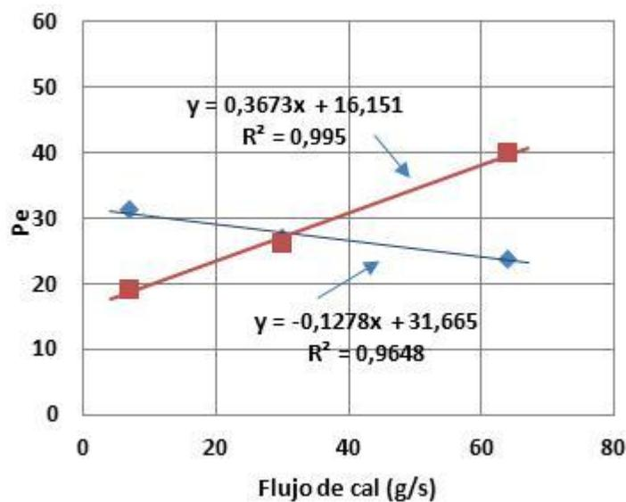
**Fig. 5** Influencia de la velocidad de rotación y del flujo de alimentación de sólidos al reactor e n el número de Peclet.
