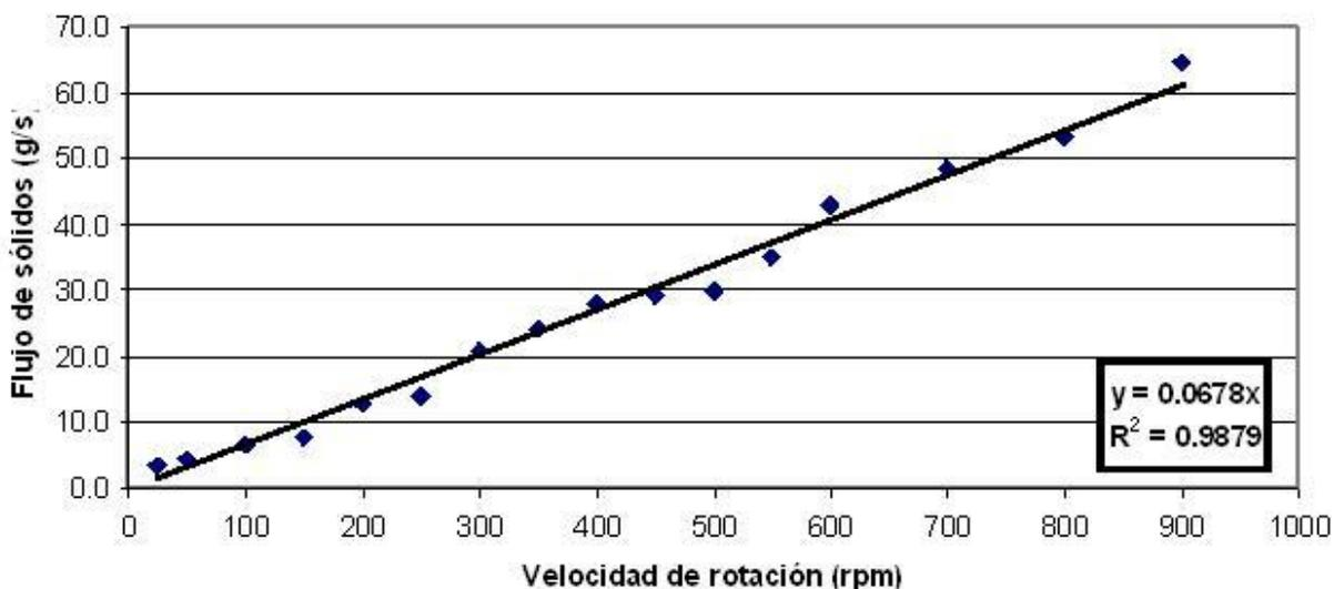
**Fig. 2 Curva de calibración del dosificador de cal.**
