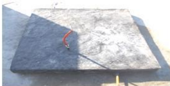
Fig 2. Foto del calentador "FIMSOL 3", hecho con materiales de la construcción
