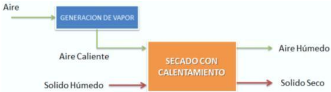
Fig 1 . Diagrama de flujo para el funcionamiento del secador de bandeja Edibon, Modelo SBAN.
