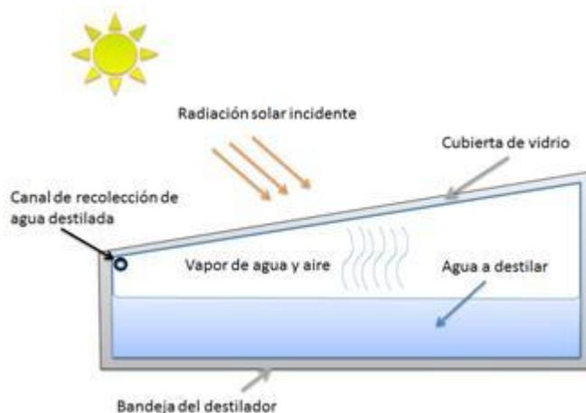
**Fig 1** . Esquema de un destilador solar tipo de invernadero de bandeja
