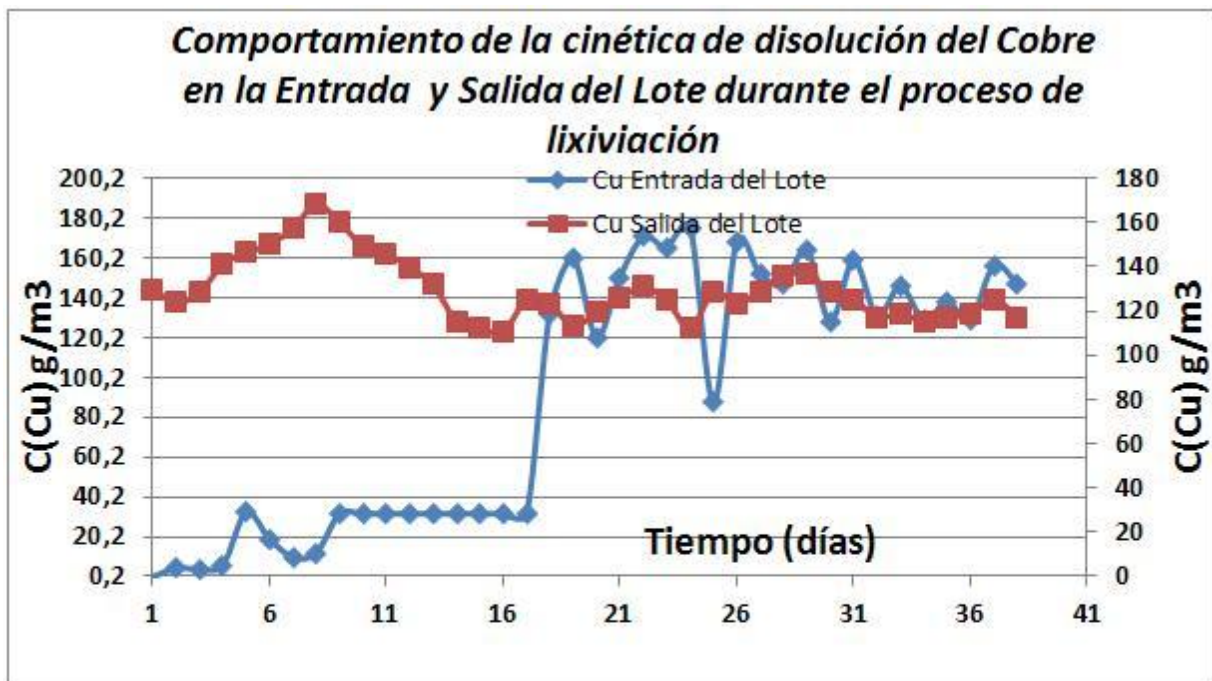
Fig. 3 Comportamiento de la cinética de disolución del Cobre a la entrada y salida del lote No 4 durante el proceso de lixiviación.
