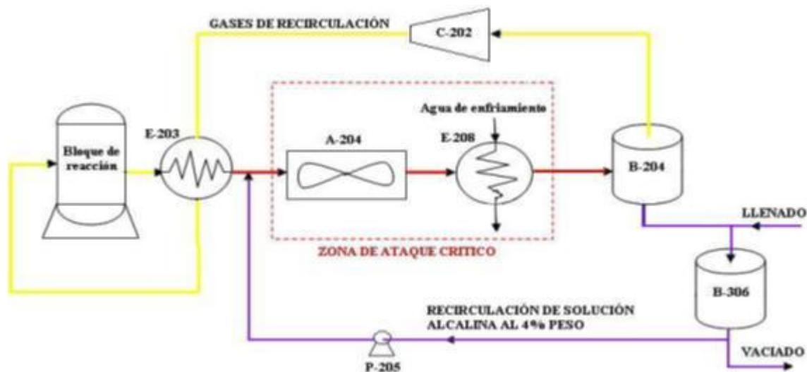
**Fig. 1 Esquema simplificado de la planta de reformación catalítica.**
