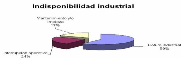
**Fig. 3 Distribución de la indisponibilidad industrial en el proceso de elaboración del mosto cervecero (proceso en caliente).**
